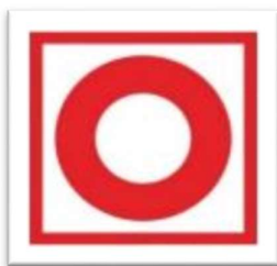
ROP – ręczne uruchomienie syreny alarmowej
